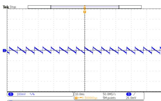
Figure 41: 264V<sub>AC</sub>/50Hz @9V/0A,  $\Delta V=82.47\text{mV}$
