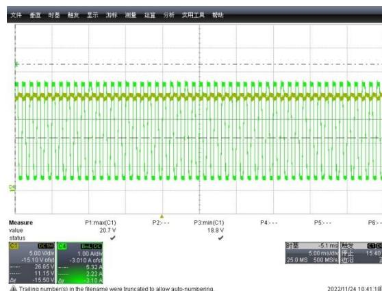
Figure 26. 264Vac/50Hz Port-C@ Vout=20V
