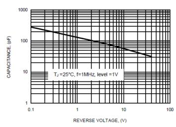
Fig. 4 TYPICAL TOTAL CAPACITANCE
