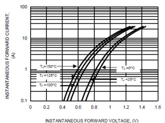
Fig. 3 TYPICAL FORWARD CHARACTERISTICS
