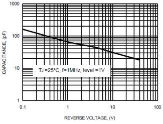
Fig. 4 TYPICAL TOTAL CAPACITANCE
