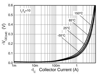
Figure 8.  $V_{CE(sat)} v I_{C}$
