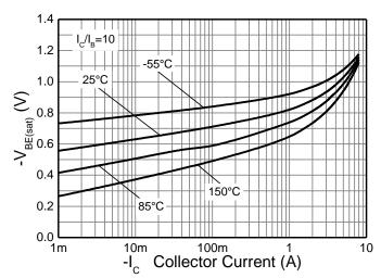
Figure 12.  $V_{\rm BE(sat)}$  v  $I_{\rm c}$
