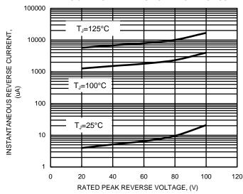
FIG.5 TYPICAL REVERSE CHARACTERISTICS
