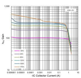
$h_{\text{FE}} \text{ vs } I_{\text{C}}$
