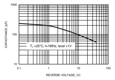
FIG.6 TYPICAL CAPACITIVE CHARGES
