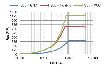
Figure 29. f<sub>SW</sub> vs. Load
